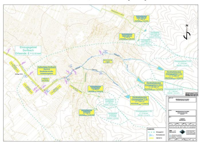
Insgesamt sieben Rückhaltebecken sind laut Berechnung erforderlich, damit der Hochwasserschutz für das Ortsgebiet hergestellt werden kann. Die Rückhaltebecken müssen entsprechend dimensioniert sein, damit bei einem HQ100 die maximale Wassermenge, welche vom Berg in die Ortschaft rinnt, nur so viel ist, wie der Ortsbach an seiner engsten Stelle fassen kann.
