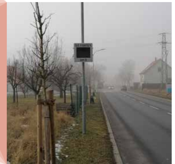
ORTSEIN- UND -AUSFAHRTEN An den Ortsein- und -ausfahrten wurden Tempomessgeräte zur Selbstkontrolle der Fahrer angebracht
